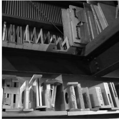
貼りの作業に欠かせない型枠。作業の基準となる「ものさし」だ。この型枠に土台部分をはめ込み、上貼紙を貼り込む。「これがうちの財産だね」と八峠社長。
