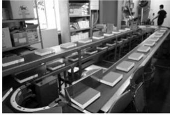
「下固め」した本体を、乾燥・冷却させるためのライン
