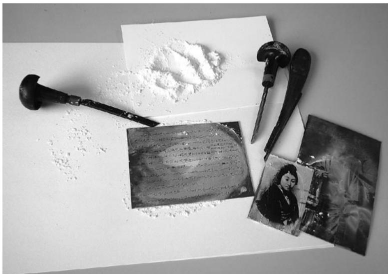
アミ点を調整する「ラインツール」と原版。ラインツールは150線用と175線用の二種類があった。炭酸マグネシウムの白い粉を凹部に摺り込みながら、アミ点を確認し、原版を調整していく。
