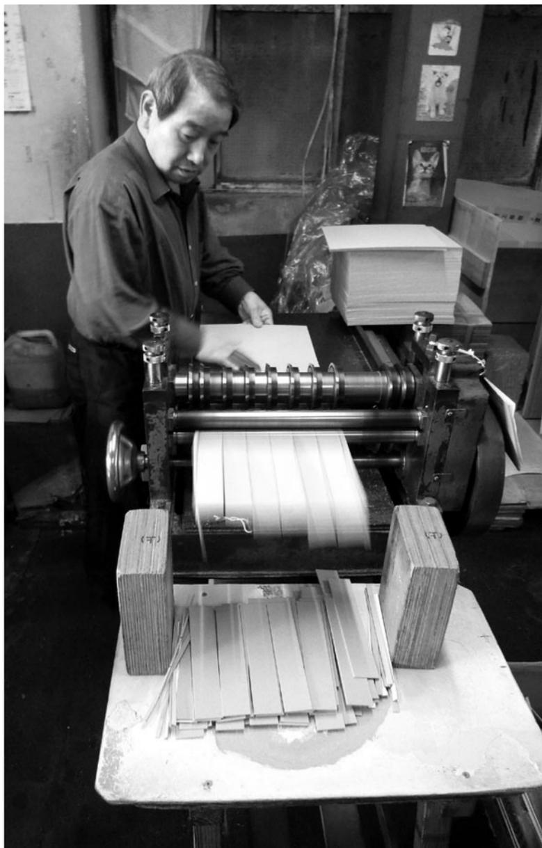
底ボールを断つ。目にもとまらぬ速さで、ボール紙を機械に送り込む。
