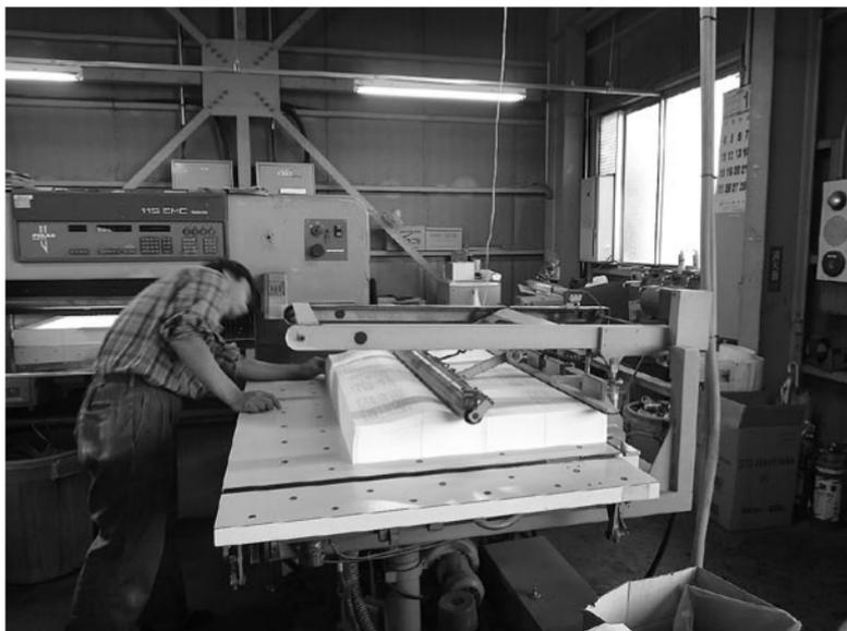
刷本に振動を与え、一枚一枚の紙の間に空気を通しながら「突きそろえ」する。
